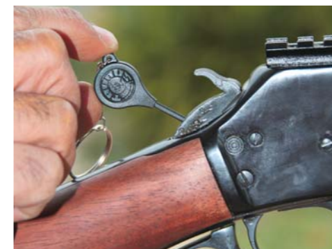
Πολύ έξυπνο κλειδίωμα της σφύρας με κλειδί.
